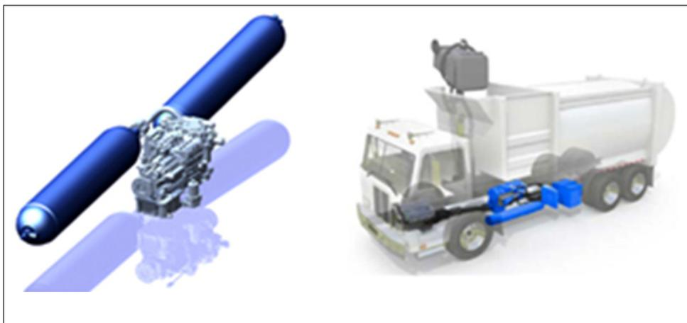
Figure 6 : Système Eaton de démarrage assisté HLA® (Hydraulic Launch Assist™)
