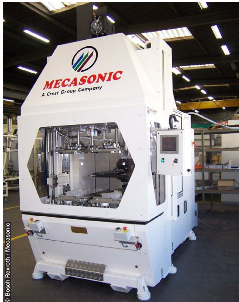
La presse Mecasonic constitue un parfait exemple de combinaison des quatre technologies de Bosch Rexroth : l'électrique, la pneumatique, l'hydraulique et les entraînements linéaires.
