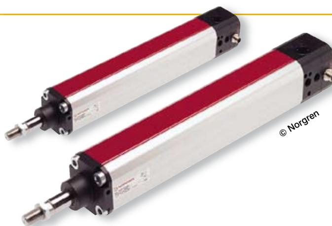
Le vérin pneumatique Integral « Smart » de Norgren respecte complètement la norme ISO et intègre dans ce faible encombrement normalisé, le distributeur et les capteurs de position. Complètement interchangeable avec un vérin ISO standard, cette solution est disponible avec la fonction 5/2 ou 5/3, multipôle ou bus de terrain.
