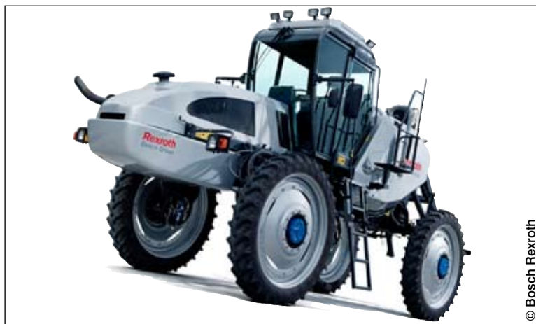
Avec le HLB (High-Performance Braking Project), le contrôle des cylindrées des pompes et moteurs pour s'adapter aux capacités de retenue du moteur thermique assure un freinage rapide et sûr sans risque d'emballement du moteur et ceci, avec une solution économique.
