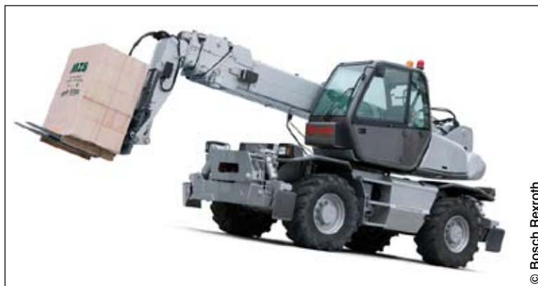
Le Diesel Hydraulic Control (DHC) se traduit par un accroissement de l'efficacité de la machine car la demande en énergie est adaptée en permanence aux besoins réels du système.
