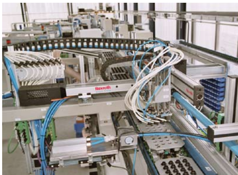
Exemple de manipulation (pick & place) avec un robot cartésien camoLINE de Bosch Rexroth : X et Y électriques, Z pneumatique
