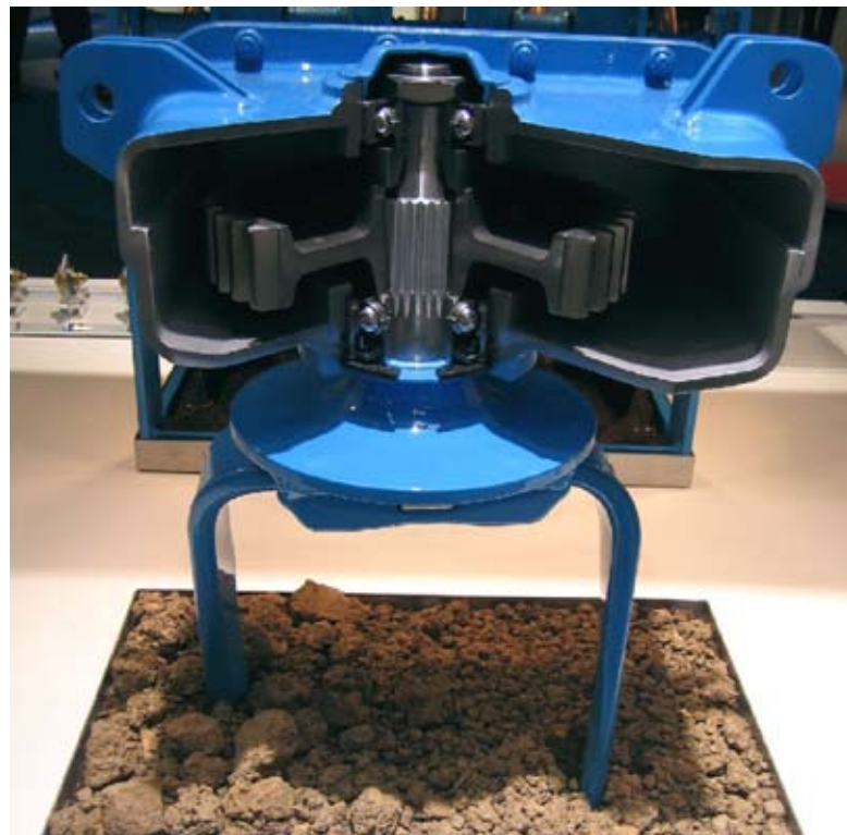
Modèle du rotor d'une herse rotative Lemken munie d'une unité de roulement NKE.
