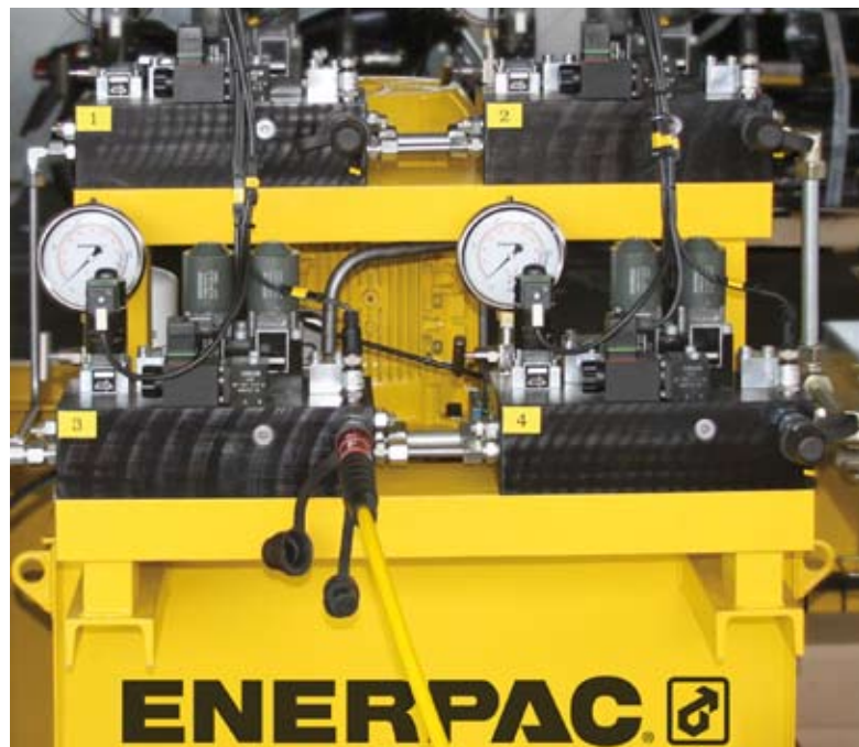
Le système hydraulique de levage synchronisé d'Enerpac a permis de mettre la croix d'appui à niveau
