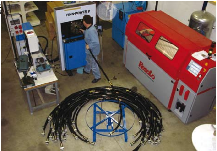
La THP s'est dotée d'une presse à sertir Finnpower de 500 tonnes pour l'équipement des flexibles
