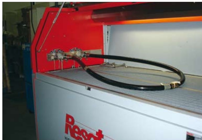
La THP teste unitairement toutes les tuyauteries avec un banc d'essais Resato PSU 7000
