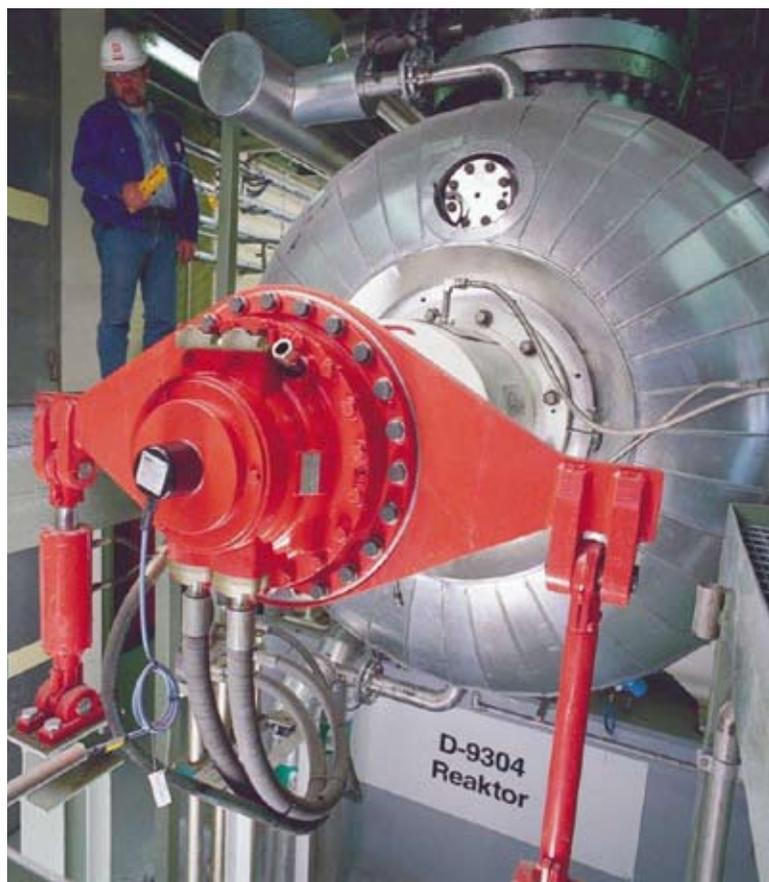
La solution Hägglunds Drives ne nécessite aucun travaux de génie civil grâce à un montage direct sur l'arbre de la machine
