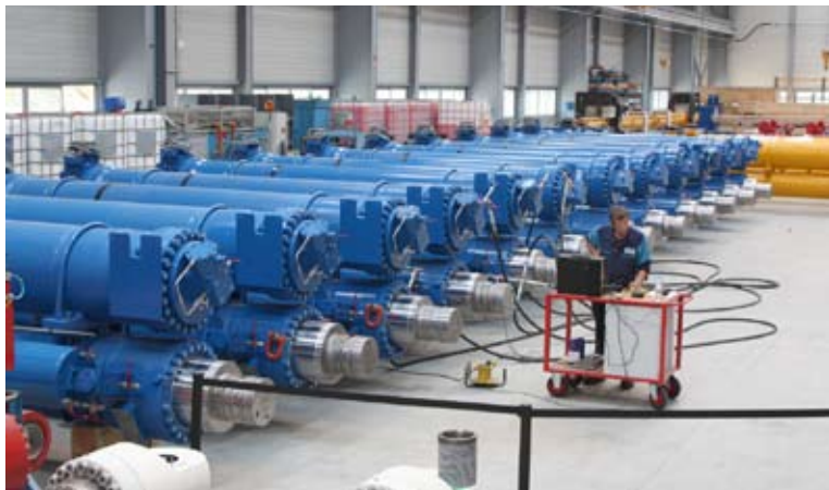
Vérins Douce Hydro pour applications de compensateurs de houle sur les plateformes pétrolières
