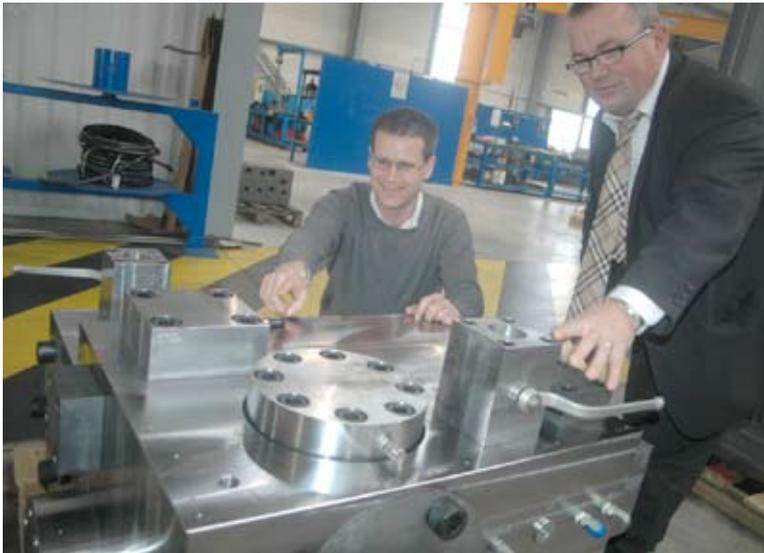
Hydraumatec a réalisé un bloc destiné à descendre à 25 mètres sous la mer comme élément de la transmission de puissance hydraulique d'un équipement destiné à fournir de l'électricité à partir de la houle marine.
