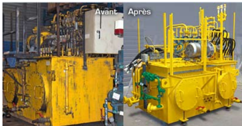
Le rétrofit d'ensembles hydrauliques s'inscrit en bonne place dans la palette de prestations proposées par Nanfourma
