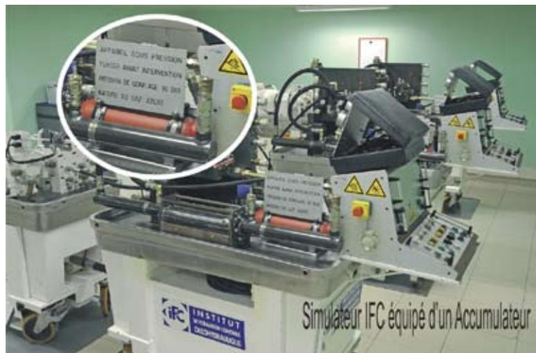
L'IFC (Institut de formation continue en oléohydraulique) préconise l'emploi d'accumulateurs hydropneumatiques qui, combinés avec des pompes de plus petites cylindrées, permettent de réduire la puissance installée tout en fournissant des débits importants au moment adéquat.
