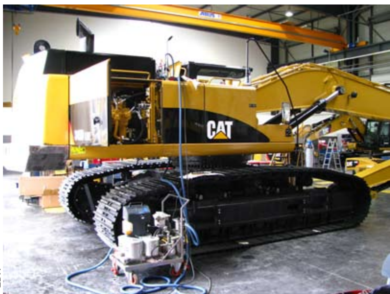
EDH préconise l'utilisation de groupes de filtration au moment de remplir le réservoir ainsi que la dépollution du réservoir lui-même avant la mise en service.
