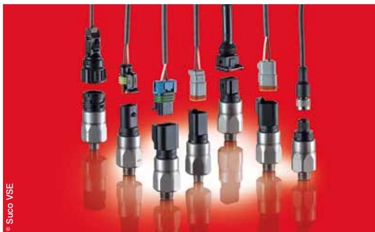
Pressostats Suco avec connecteur intégré, IP67, réglage de 0 à 200 bar, joints NBR, EPDM ou FKM.
