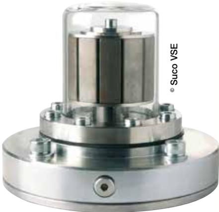
Entraînements magnétiques DST à aimants permanents hautes capacités avec cloche en Boro-silicate (suppression des courants de Foucault), de 1 à 1000 N.m, tous fluides, haut rendement énergétique.
