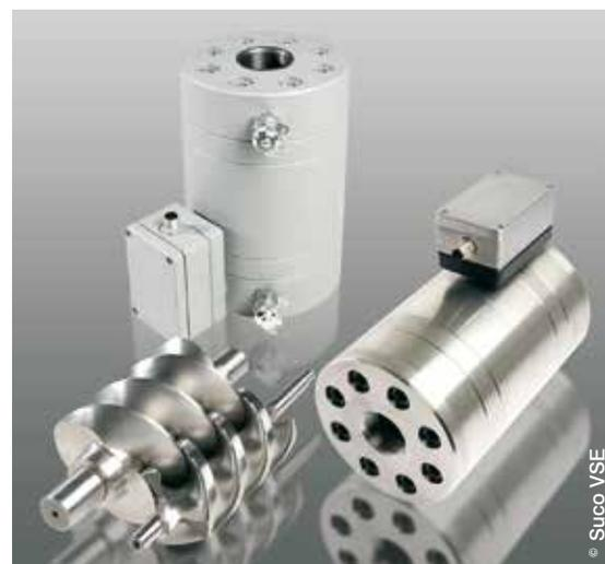
Débitmètres volumétriques VSE à vis, fonte ou inox, 450 bar, de 0,5 à 3000 l/min, précision 0,3% V.M., de 1 à 1 000 000 cSt, haute résolution, très faibles pertes de charge, afficheurs et convertisseurs en option.
