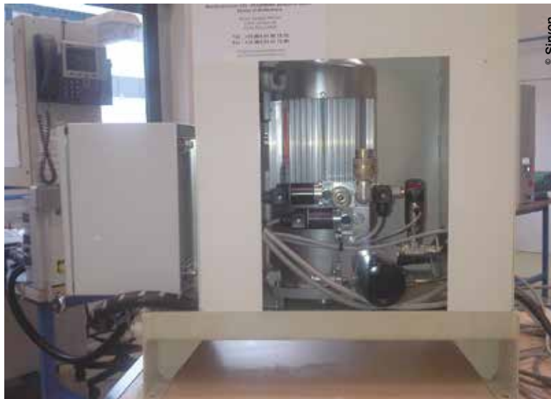
Conception et automatismes d'un système hydraulique pour 5 types de rivets huck (300/700bar) pour le rivetage des ailes de l'A350.
