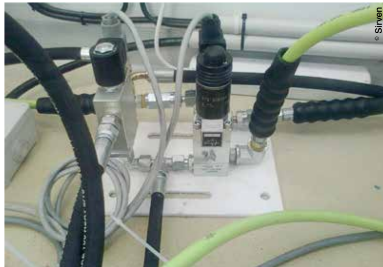
Conception et automatismes d'un système hydraulique pour 5 types de rivets huck (300/700bar) pour le rivetage des ailes de l'A350.
