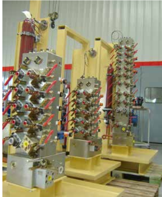
Blocs forés équipés. Protection de la distribution par armoire en acier inoxydable 316L.
