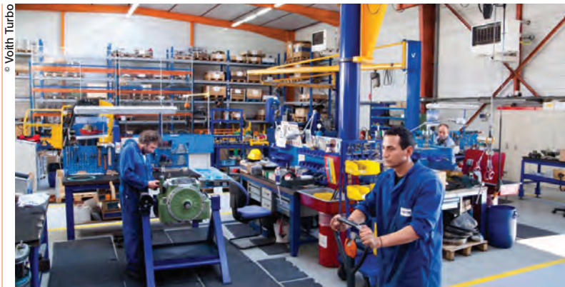
Le banc d'essais de pompes hydrauliques de l'atelier de Noisy-le-Grand a bénéficié d'un retrofit complet lui permettant de fonctionner jusqu'à des pressions de 400 bar et des cylindrées de 250 cm 3 .
