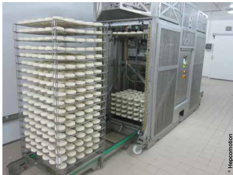
Parmi les solutions de guidage proposées par la société HepcoMotion, on peut citer le système SL2 composé de galets et de rails plats et à talon (monté ici sur un retourneur automatique de clays de fromages de la société IDEC).
