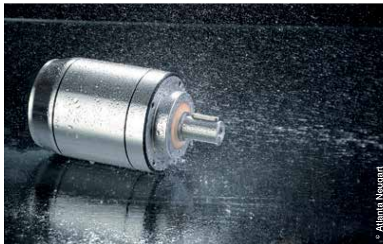
Le nouveau réducteur planétaire HLAE d'Atlanta Neugart est conçu sans bague de serrage apparente, ce qui lui permet d'être facilement nettoyé et désinfecté. Agréé FDA et NSF, il est IP69K et son corps est en acier inoxydable électro-poli 316L.
