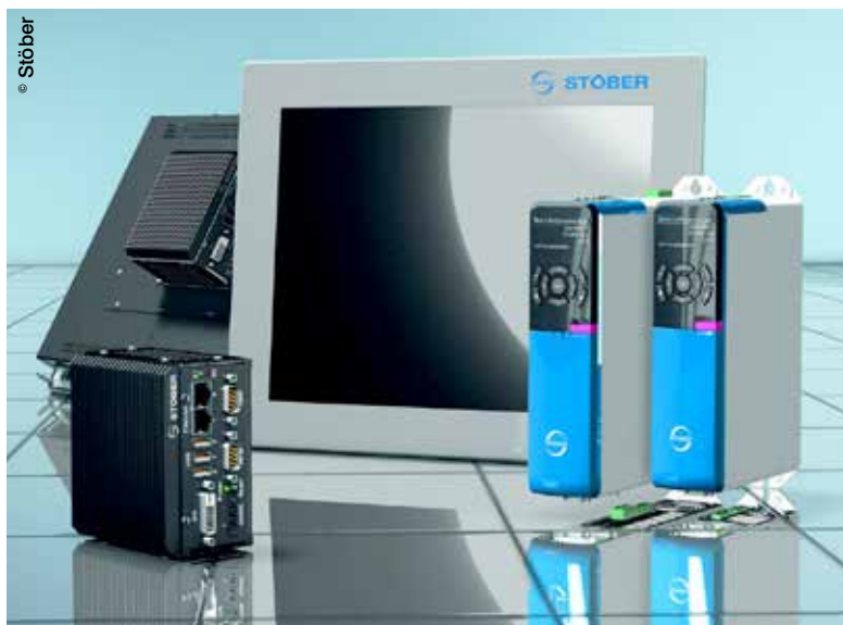
Le servovariateur SD6 de Stöber est doté de boucles d'asservissement très rapides (62.5 \mu s) grâce auxquelles on obtient une grande rigidité dans l'asservissement du moteur. Ce qui autorise de plus grands rapports d'inertie entre le moteur et la charge et permet ainsi de diminuer la taille du moteur.
