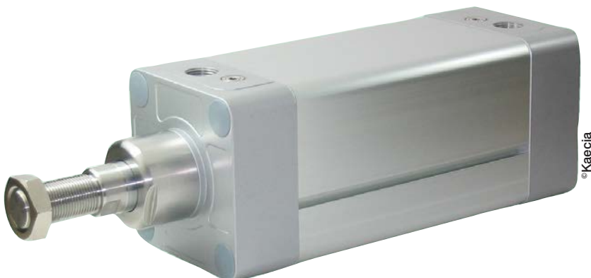
Dans le but de réduire les fuites des joints de tige sur les vérins pneumatiques, Kaecia (ex-Kuhnke) propose en option sur les modèles standard ISO 15552 un « nez » en acier inoxydable muni d'un racleur en polymère HR.
