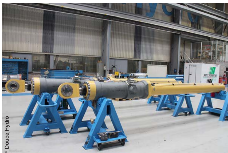
Douce-Hydro a breveté le système de sécurité Keralock®, système d'auto-blocage de tige instantané.
