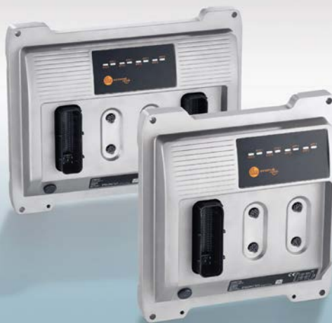
ifm electronic a développé sa troisième génération de contrôleur, ecomat Controller, qui réunit le contrôle standard et de qualité dans le même boîtier.
