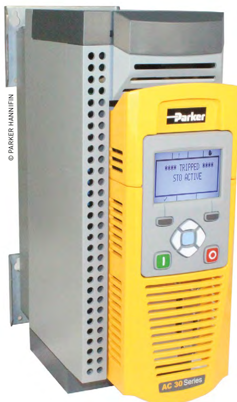
Le variateur AC30 de Parker permet le partage d'énergie entre différents récepteurs connectés sur son bus continu. Associé à des fonctionnalités de régénération réseau type AFE, il permet des économies d'énergie pour tout type d'applications industrielles.
