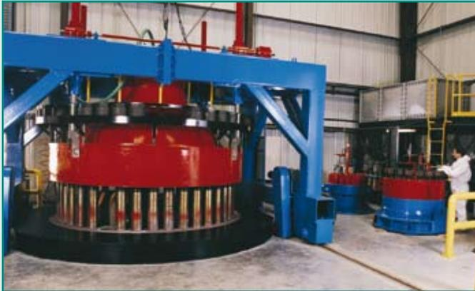
Hydrospace, centre d'essai de la société Balmoral, situé à Houston (Texas), teste dans ses chambres d'essais les équipements pétroliers sous-marins qu'elle conçoit. Les tests simulta-
